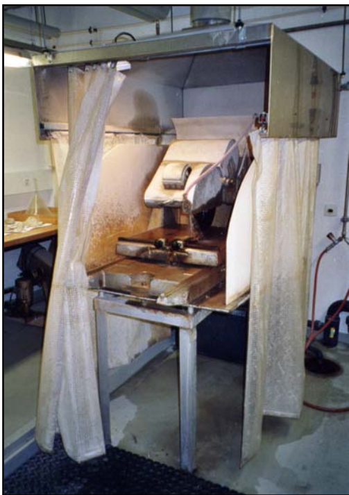
Cette photo représente la première scie servant à découper le morceau souhaité.
